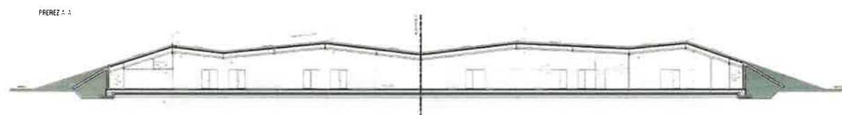
Slika 21: Vz dolžni prikaz prereza zelene pohodne strehe.
